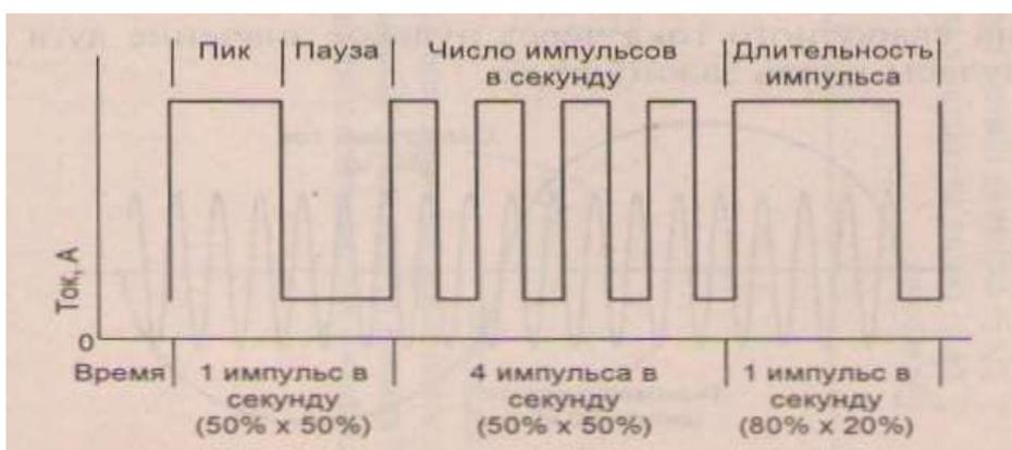
Рис.10. Влияние основных регулировок на форму импульса
